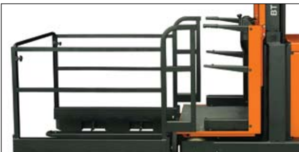
Les modèles « W » de série M présentent une ouverture frontale pour la manutention d'objets encombrants.
