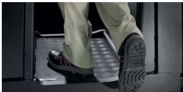
La marche basse d'accès du BT Optio réduit l'effort du cariste lors des entrées et sorties répétées du chariot. Le chariot est équipé d'un plancher suspendu atténuant les vibrations
