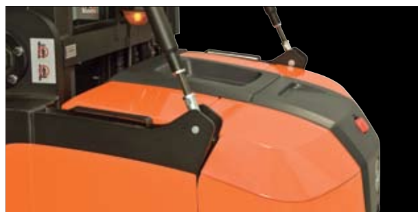
Pour davantage de légèreté, les pièces non exposées telles que le capot de batterie sont en plastique
