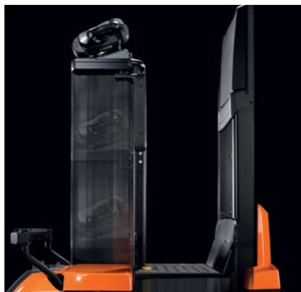
Les modèles BT Optio série L dotés d'une plateforme élévatrice sont également équipés de commandes élévatrices qui permettent de piloter le chariot sans avoir à baisser la plateforme.
