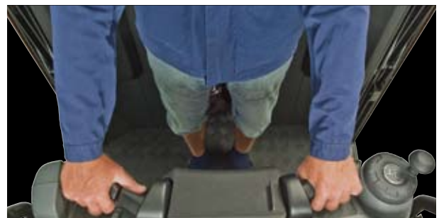
Le système de présence multiple assure que le cariste se trouve bien en sécurité dans la cabine avant tout mouvement du chariot
