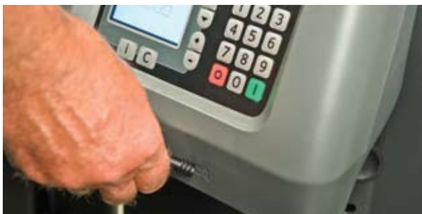
Le BT Optio série H démarre avec un code PIN ou une clé d'identification (en option)
