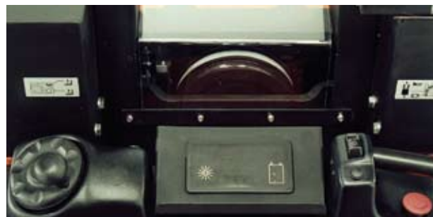
L'affichage détaillé indique la hauteur de levée, l'état de la batterie et la position de la roue motrice, ainsi que les alarmes et codes d'erreur.
