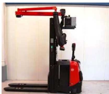
↑ Photo 1 : L'accessoire est totalement intégré au gerbeur. La pompe à vide est montée à l'arrière
